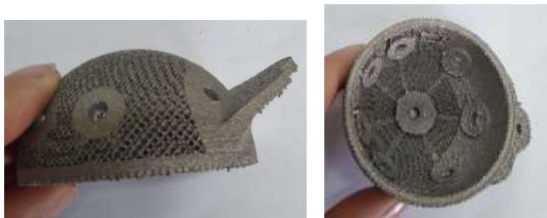
Результат SLM друку ацетабулярної чашки (матеріал ВТ6)
