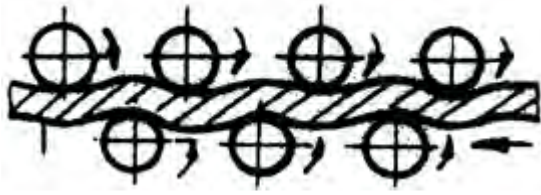
Рис.6.1. Схема виправлення листового прокату на багатороликівих вальцях
