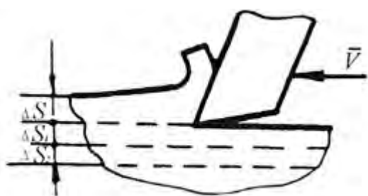
Рис .1.1 Напрямок головного робочого руху \bar{V} і дискретної подачі \Delta S при струганні
