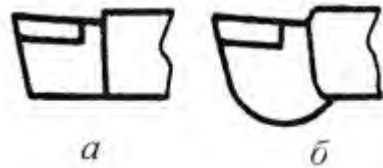
Рис.6.4. Відрізні різці звичайні (а) і підвищеної міцності (б)
