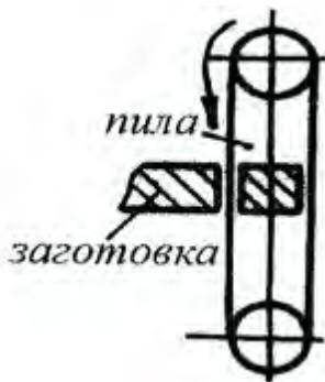
Рис.6.7. Розрізування прокату стрічковою пилою
