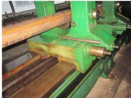
Заготовка, встановлена на лінеті
