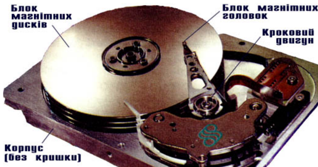
Рис. 4.12. Устрій сучасного жорсткого диска
