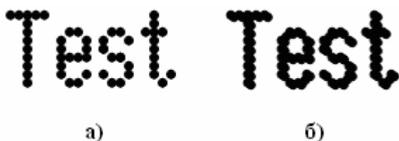
Рис. 5.3. Підвищення якості матричного друку а - однопрохідний друк, б - багатопрохідний друк
