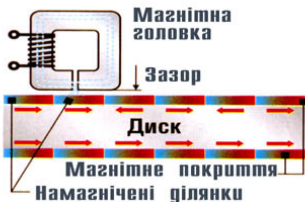
Рис. 4.10. Запис інформації на магнітний диск
