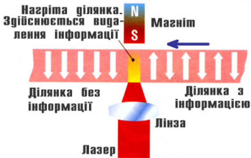
Рис. 4.18. Магнітооптичний принцип руйнування інформації
