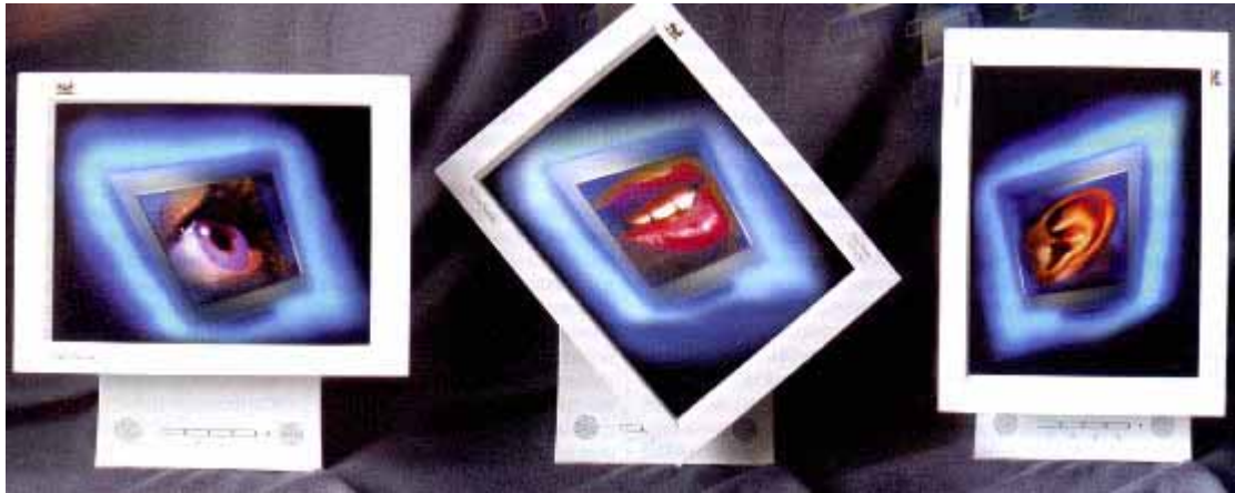
Рис. 4.22. Рідкокристалічний монітор з поворотним екраном
