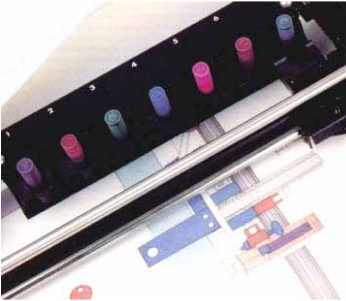
Рис. 5.11. Каретка плоттера з рапідографами
