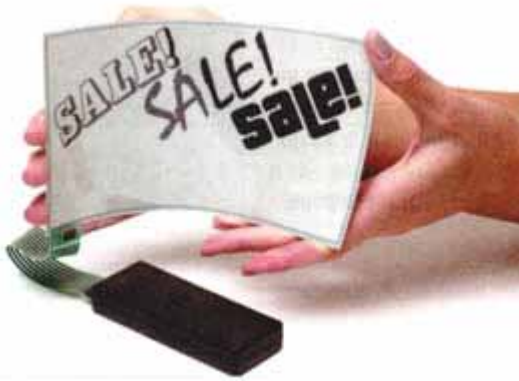
Рис. 4.27. Тонкий і гнучкий аркуш електронного паперу
