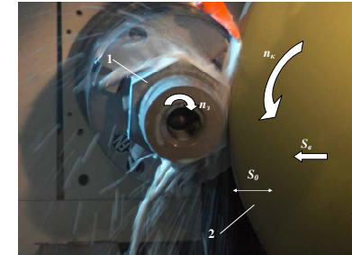
Рис. 1. Схема врізного некруглого шліфування.
