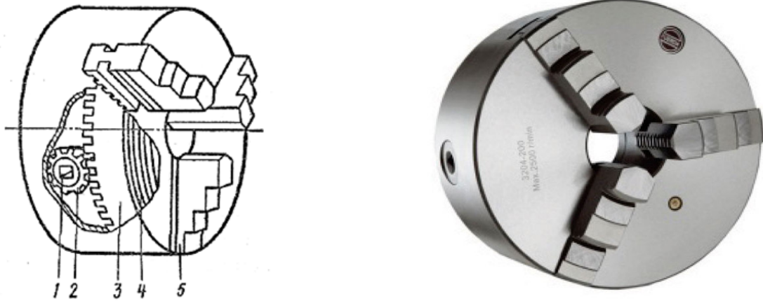
Рис. 2.1. Трьохкулачковий спірально-рейковий патрон: 1 – отвір під ключ, 2 – ведуча конічна шестерня, 3 – зубчасте колесо, 4 – спіраль, 5 – кулачок
